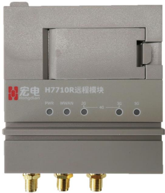
图 4-1 H7710NR 远程通信模块实物图
