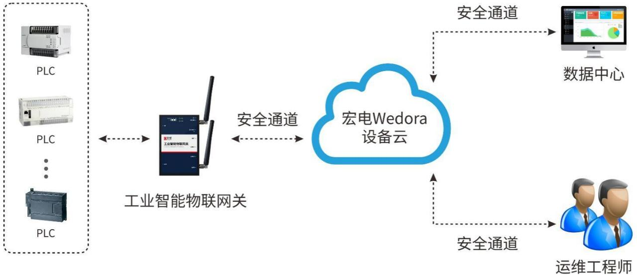
图 1-1 智能工厂设备无线联网应用示意图
