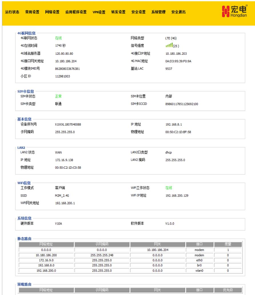
图5-4 工业智能物联网关设备 WEB 配置界面
