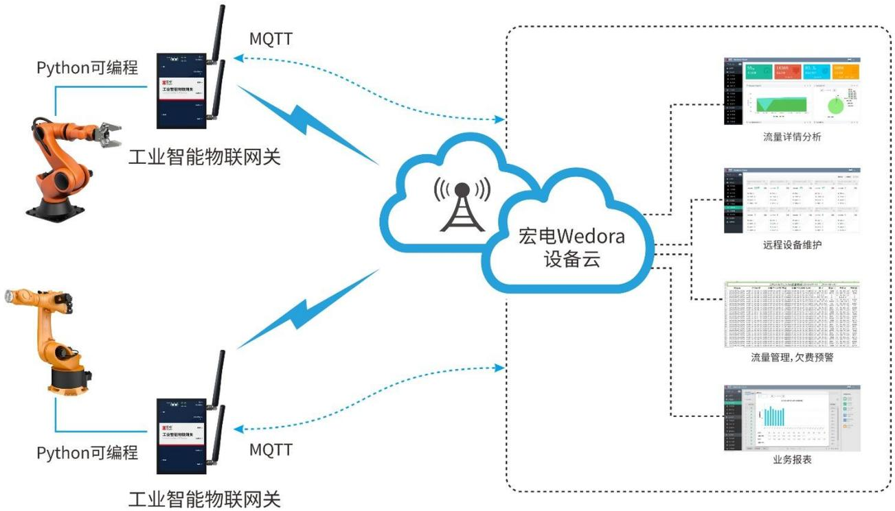
图 1-2 工业机器人远程智能运维示意图
