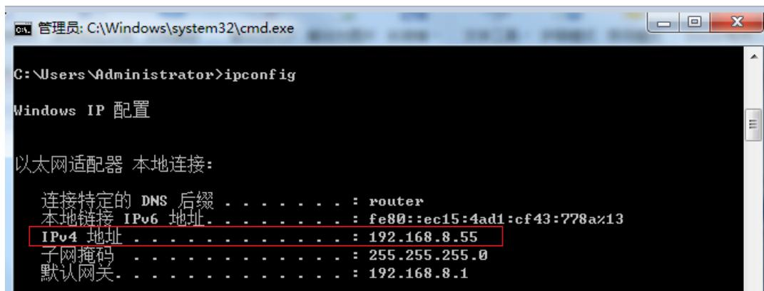
图4-12 DHCP 自动获取 IP 方式“ipconfig”执行结果
