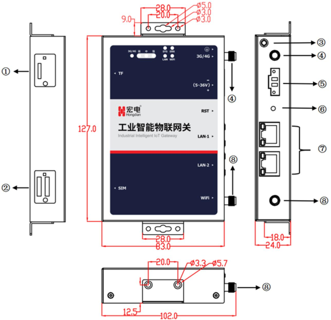
图2-2 工业智能物联网关结构尺寸图
