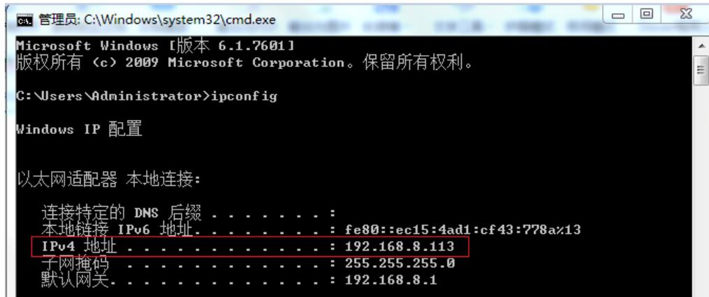
图4-11 指定 IP 方式的“ipconfig”执行结果
