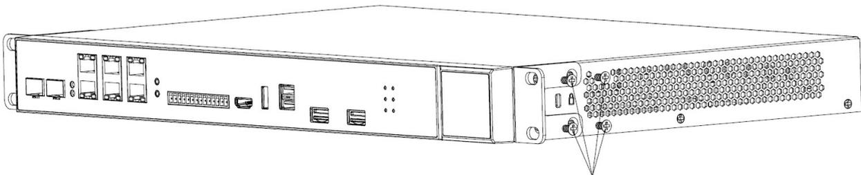
说明：1. 安装支架2PCS，M4螺丝8PCS，两侧共锁8个螺丝孔。
